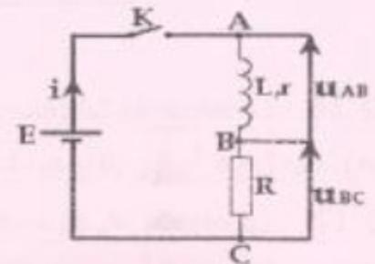
Un dispositif permet de suivre les valeurs des tensions
